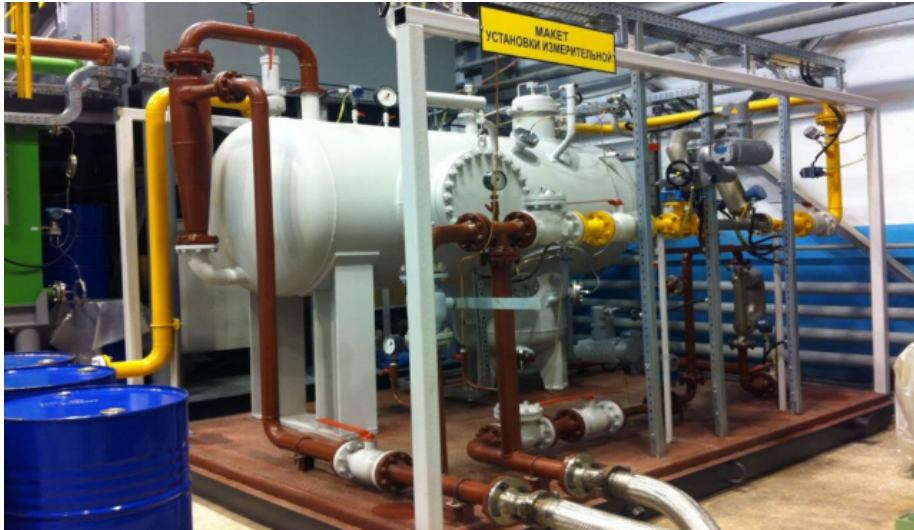
Рис. 2. Поверяемая измерительная установка. Установка состоит из сепарационного бака белого цвета, двух электроприводных задвижек на жидкостной и газовой линии и кориолисовых расходомеров.
